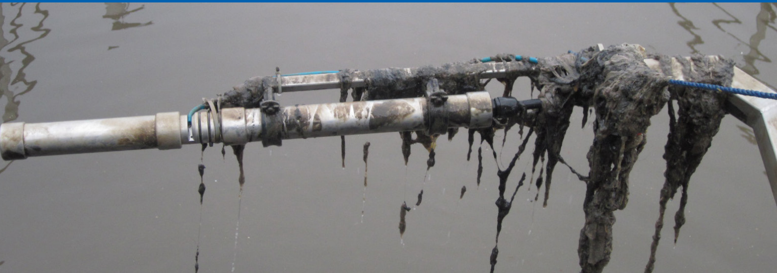
Sensor med skidt fra spildevand Foto: Ravi Kumar Chhetri, DTU Miljø
